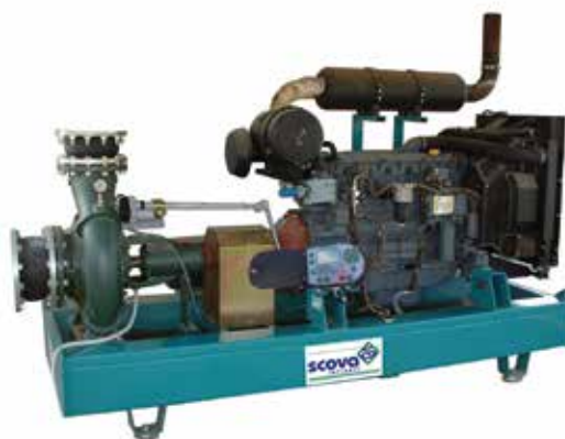
Applicazione della centralina ALPHA 6 su gruppo motopompa
